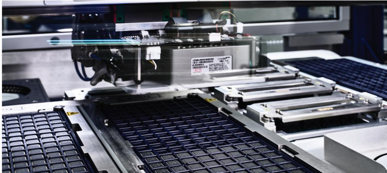
Unser Programmierservice entlastet die Bestückungslinien unserer Kunden, indem bereits vorprogrammierte Bauteile der Bestückung zugeführt werden können (Off-Line Programming). Das zeitliche Einsparpotential ist bedeutend und ermöglicht dem Kunden einen höheren Durchsatz.
