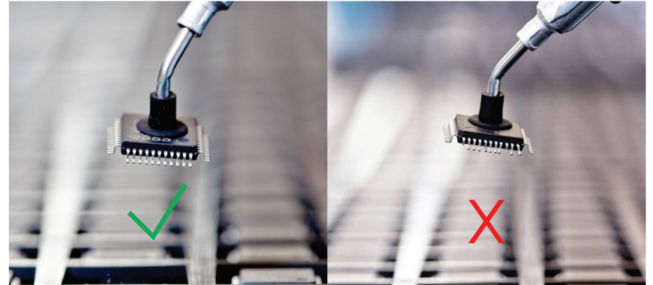
Im Testhaus Wareneingang werden Anlieferungen einer weitgehenden Prüfung unterzogen. Beistellungen im Auftrag des Kunden über Dritt-Lieferanten bedingen eine intensive visuelle Prüfung. Der Abgleich von Typ und Stückzahl, Verpackungsart und -materialien, Kennzeichnung, Beschriftung, der Zustand von Bauteilgehäusen und Bauteilanschlusspins können je nach Herstellungsdatum, Herkunft und bisheriger Lagerung von den Vorgaben bzw. Angaben auf den Lieferdokumenten abweichen.
