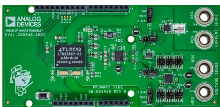
CN0548: Isoliertes Hochspannungs- und Hochstrom-Messmodul Weiterlesen (Englisch)
