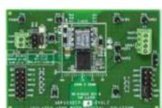
**ADP1032:** zweikanalige, isolierte Mikropower-Management-Einheit mit sieben digitalen Isolatoren
