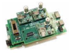
**CN0428:** System zur Messung der Wasserqualität
