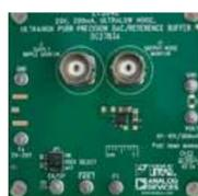
**LT3040:** ultrahoher PSRR-Präzisions-DAC/Referenzpuffer mit 20V, 200mA und ultraniedrigem Rauschen
