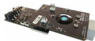
**AD-96TOF1-EBZ:** 3D-Time-of-Flight-Entwicklungsplattform Ab Januar verfügbar
