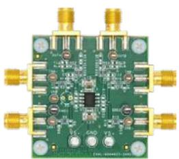
**ADA4625-2:** Rauscharme, schnell einschwingende Einzelversorgung mit 36V, 18MHz, RRO und JFET-Operationsverstärker
