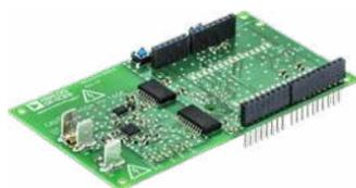
**ADE9153A:** Schaltung zur Energiemessung mit mSure®-Autokalibrierung
