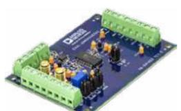
**ADM3057E:** Signal- und leistungsisolierter CAN-Transceiver für CAN-FD mit 3kV Effektivspannung
