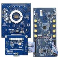
AD-FMCLIDAR1-EBZ: Das AD-FMCLIDAR1-EBZ ist eine bewährte modulare Hardwareplattform für die Entwicklung von 1D-non-Scanning-LiDAR-Anwendungen
